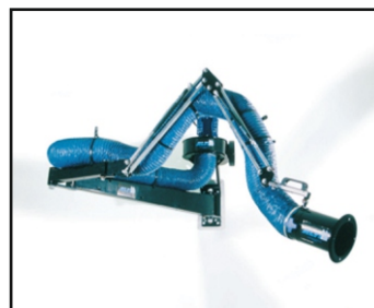
Rameno typu ES prodloužené o další výklopný závěsný systém s délkou 6 m.
