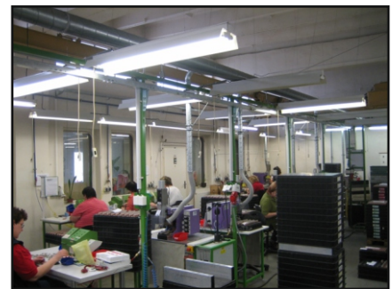
ABB, provozovna Brno - filtrační jednotka GM2V pro odsávání 11-ti pájecích pracovišť při výrobě elektrických jističů.
