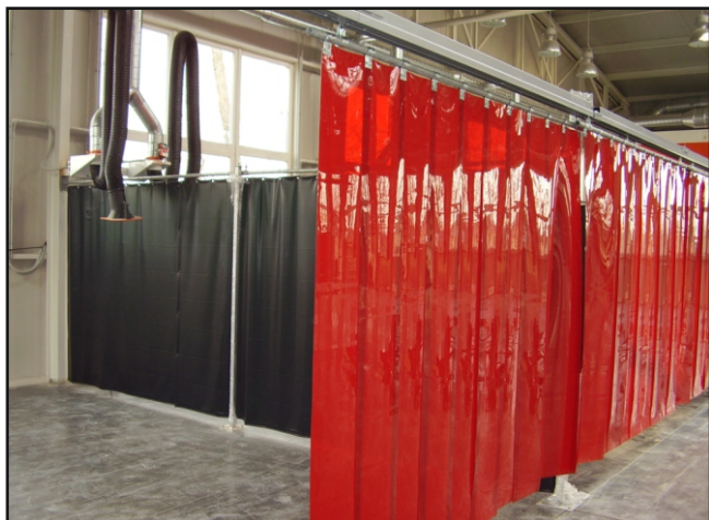
Kornfeil spol. s r. o., Čejč - svařovací boxy, kdy boční stěny jsou tvořeny zástěnou T75M, vstup do boxů je přes lamelovou stěnu tmavosti T40.
