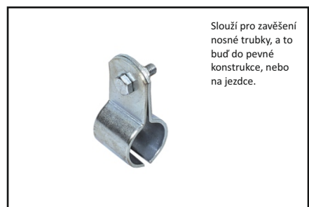
Trubková upínka PIPE CLAMP obj. č.: WZ-R-SCHELLE
